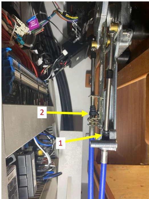
Abbildung 6 Zug- und Druckkabel zum Getriebe identifizieren (1 Getriebe seitlich, 2 Gas mittig)
