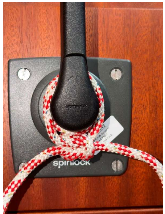
Abbildung 4 mit Kreuzknoten gesicherte Wicklungen
